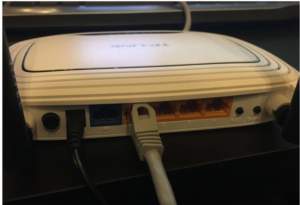
Das andere Ende des LAN-Kabels mit dem Computer verbinden, auf dem die Firmware heruntergeladen wurde und mit dem die Aktualisierung durchgeführt werden soll.
